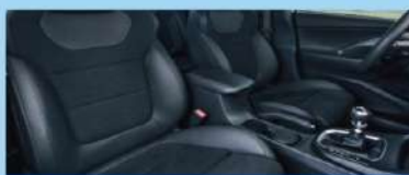
Sportsitze mit verstellbarer Oberschenkel- auflage und elektrisch einstellbarer Lenden- wirbelstütze (Fahrer Serie, Beifahrer optional)
