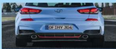
Sportabgasanlage mit zwei Endrohren und variabler Klappensteuerung 2
