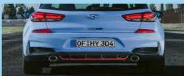
Sportabgasanlage mit zwei Endrohren und variabler Klappensteuerung<sup>2</sup>
